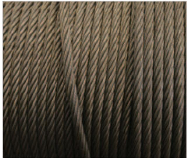
Estes cabos correspondem à construção 6x19 com alma de fibra, conforme normas ISO ABNT 2408 e IRAM 547, tanto em revestimento natural como galvanizado.
