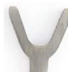
Fotografía sin retocar de una sección transversal cortada de una polea endurecida a la flama (en ácido 2-1/2 minutos)
