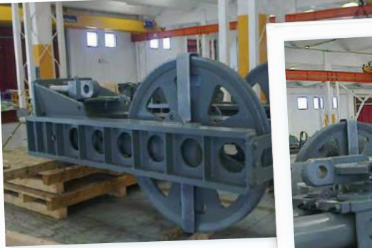
Poleas usadas para mover embarcaciones y compuertas
