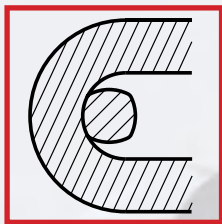
Cadena de perfil Profile Chain Fig 2. Corte transversal del área de contacto de los eslabones.
