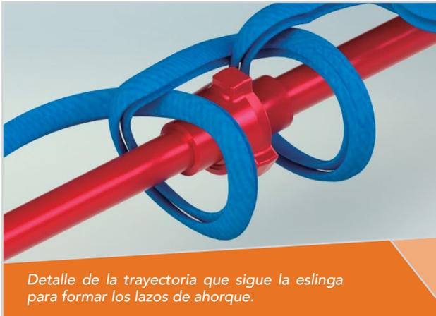
Una vez vinculada la eslinga en un punto fijo (externo a la instalación), el primer paso será identificar el primer accesorio o unión a enlazar con la eslinga TPR. Son ejemplos: codos, derivaciones, válvulas, conexiones entre dos tramos de cañería rectas a través de uniones roscadas.
