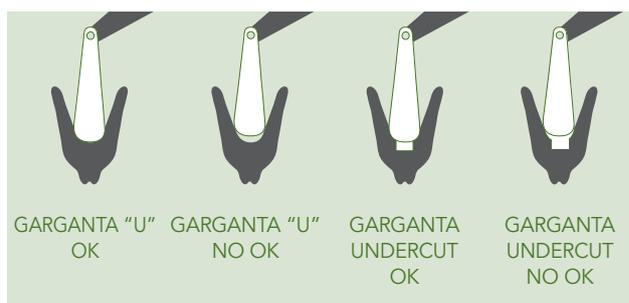
Ejemplo de defectos de desgaste en ranuras.
